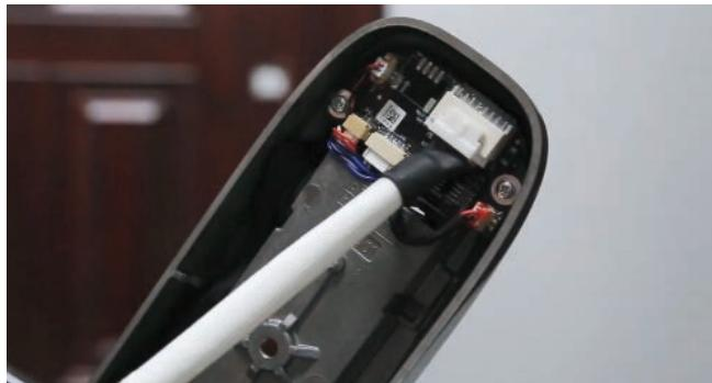
6 Drej sikringsknappen opad, og fastgør bagpanelet med skruer, som vist herunder.
